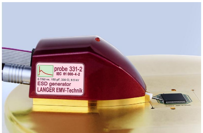
Bild 5 - Kontaktieren des DUT
